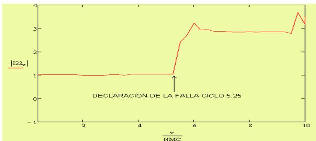
**Figura 9** Magnitud del fasor  $I_{22}$  para la falla entre espiras
